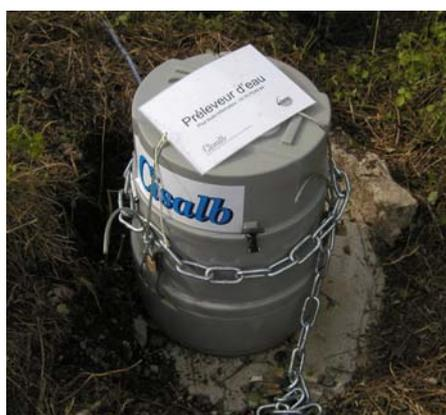
Photo 4 : Système d'attache du préleveur sur L2
